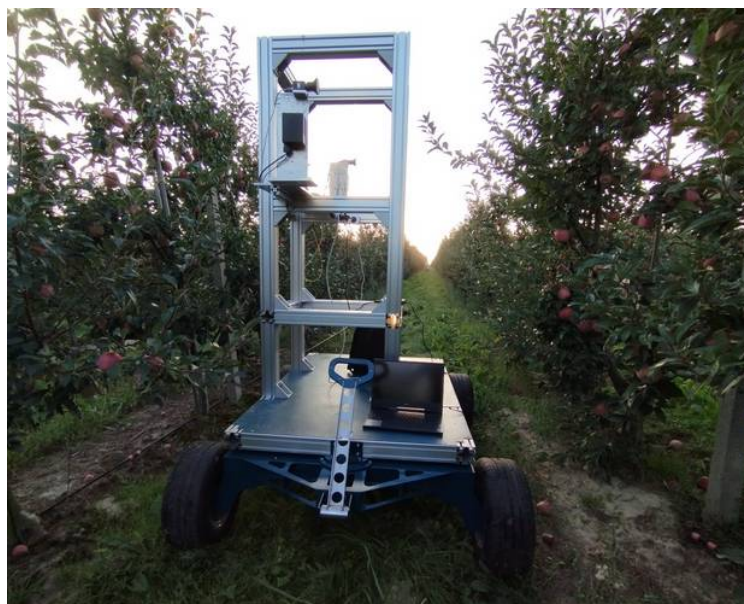
Rys. System zbierania danych podczas prac w sadzie
